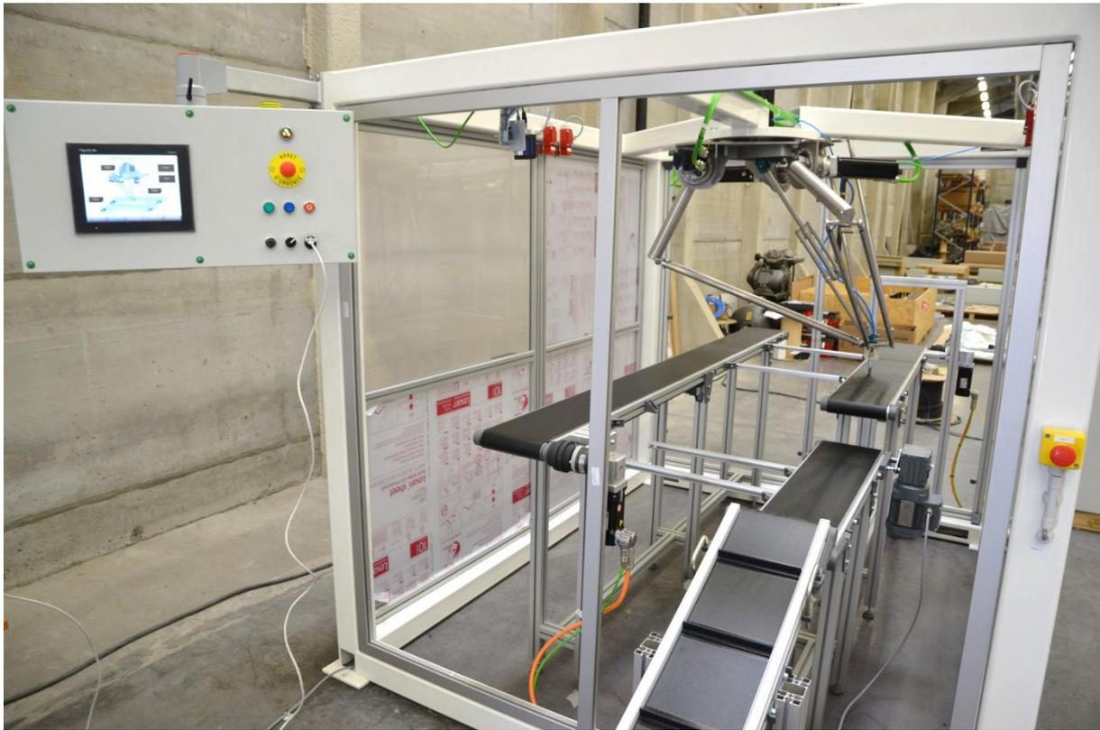
Un **robot delta** est un type spécifique de robot industriel qui utilise une architecture mécanique en forme de triangle, d'où son nom.
